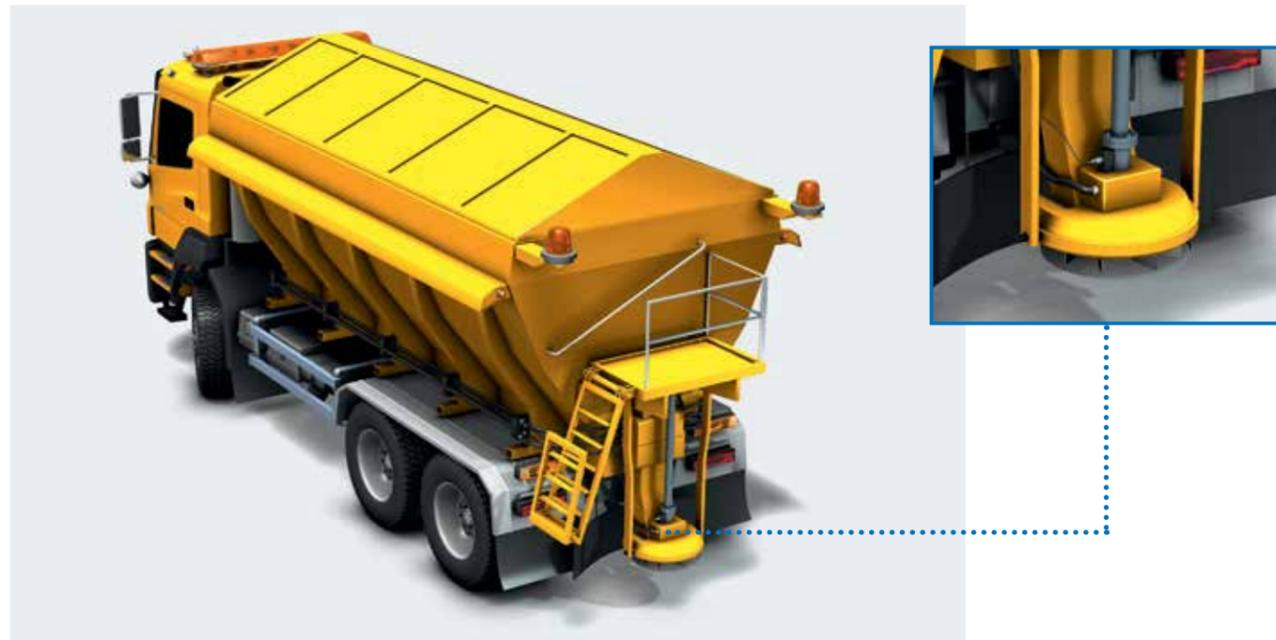
В автомобиле-пескоразбрызгивателе индуктивные датчики контролируют надлежащую скорость вращения ротора при разбрызгивании песка и химреактивов на дорогу в зимнее время. Датчики работают в чрезвычайно жестких условиях на открытом воздухе, поэтому они должны обладать высочайшей прочностью, а также стойкостью к ударным и вибрационным нагрузкам.
