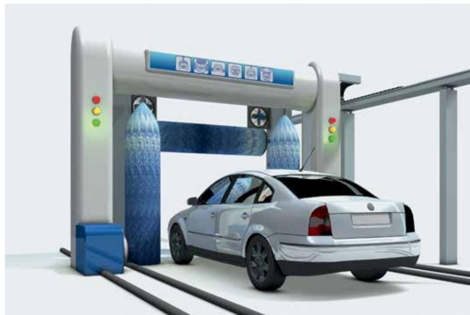
Установка для мойки автомобилей. С помощью индуктивных датчиков контролируется конечное положение автомобиля, а также текущее положение моющих щеток. Для обеспечения продолжительного срока службы должны использоваться датчики, способные работать в среде с повышенной влажностью и постоянно меняющейся температурой.
