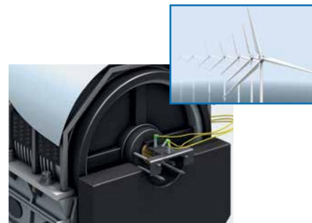
Индуктивные датчики приближения контролируют вращающийся вал ротора ветряного генератора. Стандартное золотое покрытие контактов обеспечивает высокую надежность электрического соединения и защищает контакты от окисления и коррозии в условиях повышенной влажности и вибрации, в том числе при работе в открытом море.
