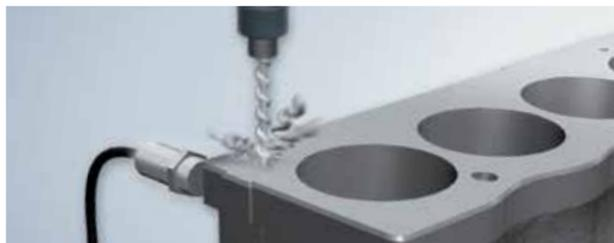
Датчик контролирует положение обрабатываемой детали, непосредственно контактируя с маслом.
